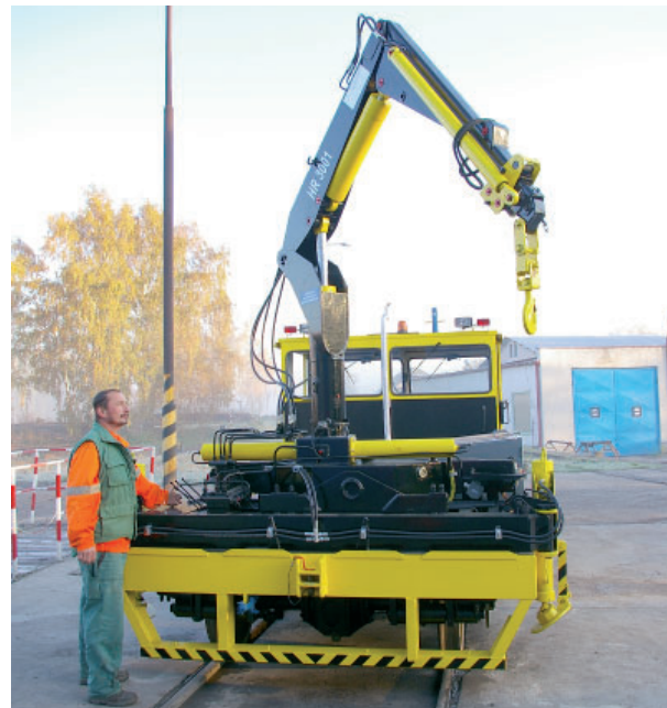
Hydraulická ruka na drezíně pomáhá zaměstnancům traťového hospodářství s nakládáním materiálu. Foto: (pim)
