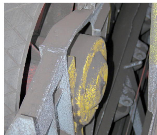
Tenhle domek je vlastně kryt na ložisko, kterým prochází hřídel. Foto: (pim)
