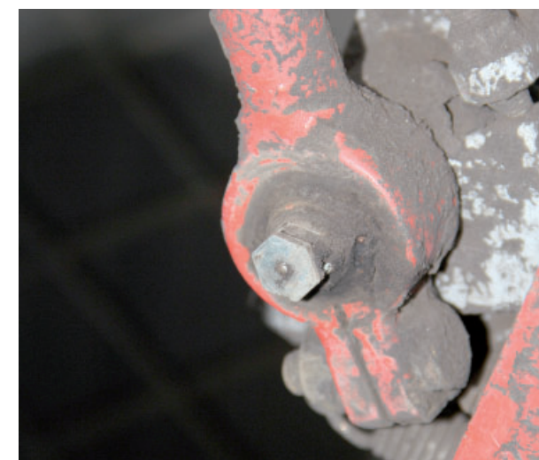
Nipl je výraz pro místo, kterým se pohyblivé součásti stroje promazávají. Foto: (pim)
