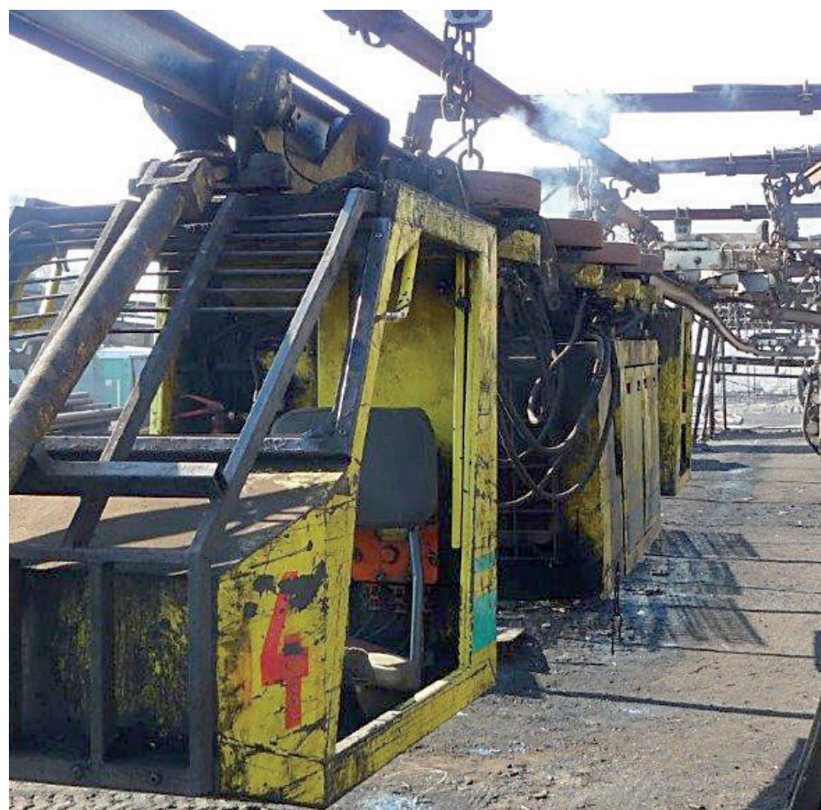
První ze závěsných důlních lokomotiv už má nový automatický zášecí systém. Foto: Důl Kohinoor
