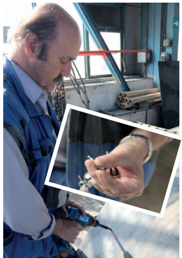
Vrtačka se speciálním nástavcem slouží „mapaři“ k odběru vzorků. Foto: (pim)
