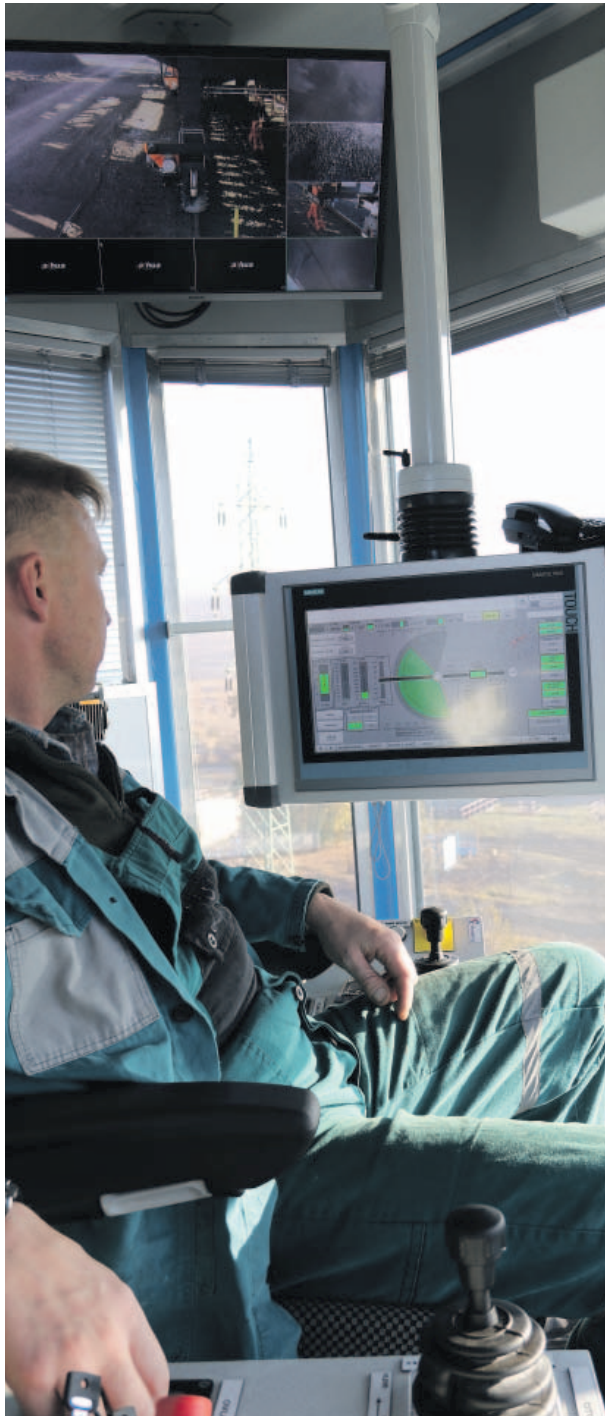
Modernizace se během oprav dočkala také kabina řidiče.
