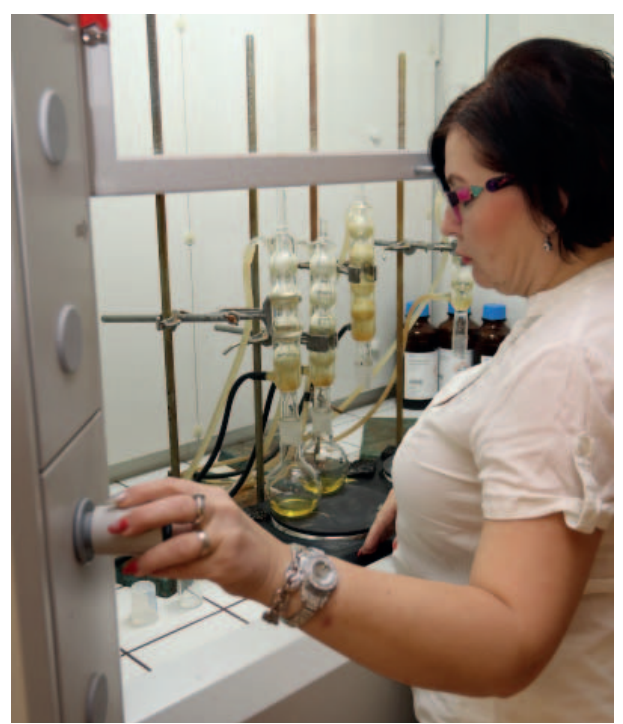
Z odebraných vzorků vody se v laboratoři provádí řada rozborů, například chemická spotřeba kyslíku. Foto: (pim)
