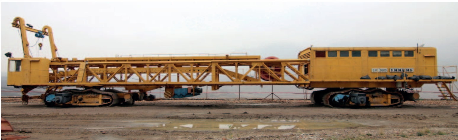
V bezprostřední blízkosti „erkáčka“ stojí dvojice zvláštních strojů. V provozu jim říkali „EÁRY“, protože označení těchto východoněmeckých vozů Takraf bylo EAR 3600. Pomáhaly právě při výměně korečkového řetězu. Foto: 5x (pim)
