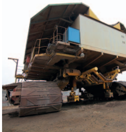
Tyto části technologie by se hodily i do Hvězdných válek, drtiče ovšem hlavně drtí natěžený materiál na menší kusy, aby se nepoškodila těžební technologie.
