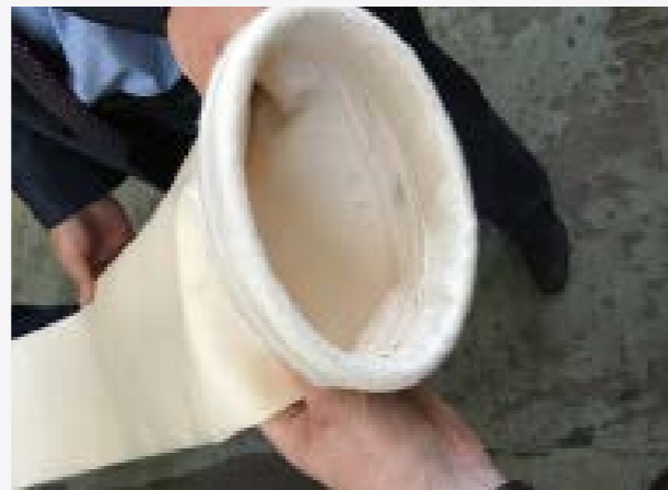
Obrázek 4: Látkový filtr v Teplárně Kladno
